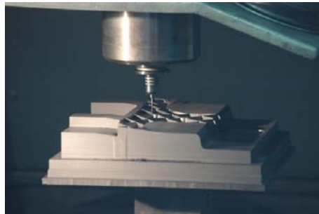
Das Unternehmen aus Velbert konstruiert, programmiert und fräst Graphitelektroden auf speziellen Graphit Fräsmaschinen im Hause; so bleibt ein Maximum an Flexibilität erhalten.
